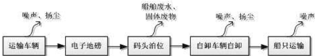
图 3-5 生产工艺流程及产污节点图
